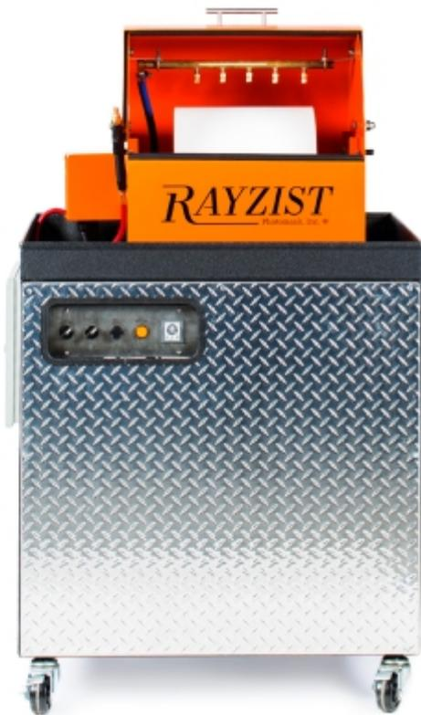
Für die industrielle Serienfertigung haben wir dieses automatische Auswaschsystem für unsere fototechnischen Sandstrahlfolien entwickelt. Die automatische Entwicklung garantiert eine gleichbleibende Qualität der Sandstrahlmasken, unabhängig davon, welcher Mitarbeiter die Anlage bedient.
